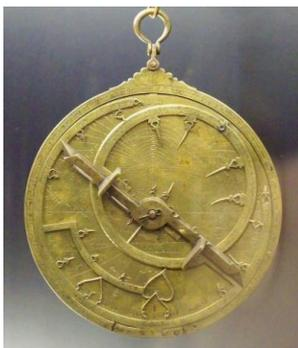
El **astrolabio** es un instrumento de precisión utilizado durante siglos; con él se determinan la posición y altura de las estrellas sobre la bóveda celeste; su nombre en griego significa «buscador de estrellas» y era utilizado tanto por navegantes, como por científicos para localizar los astros, observar su movimiento y así determinar la hora a partir de la
